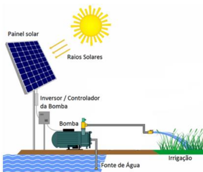
Figura 1 - Configuração de um sistema de bombeamento fotovoltaico para irrigação Fonte: Adaptado do site Elétrica & Cia (2020).
